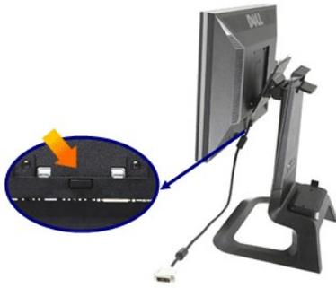
2. Saisissez le bas du support. Il y a deux onglets métalliques en haut de la plaque VESA, qui s'insèrent dans le moniteur. Tirez le bas du moniteur pour le sortir du support, en faisant attention à ne pas rayer le moniteur avec le support.
