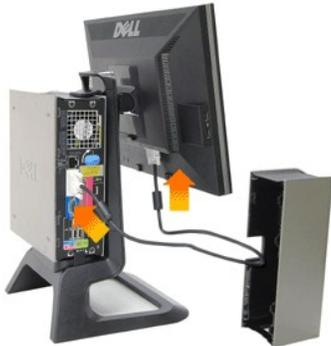
4. Faites passer le câble d'alimentation du moniteur à travers l'ouverture au bas du cache câble et branchez-le sur la prise pour cordon d'alimentation au dos du moniteur
